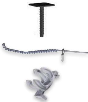
En caso de utilización de mortero autonivelante se debe fijar el aislante MARA5 y MARA10 a la solera utilizando las fijaciones SRCLIP-S. Dimensión: base 40 x 40mm; longitud 60mm; diámetro 8mm.
