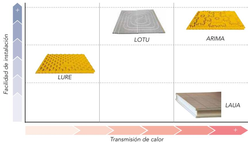
Cuadro sobre la eficiencia en transmisión térmica de las soluciones de Suelo Radiante Refrescante Orkli, en base a sus diferentes paneles.
