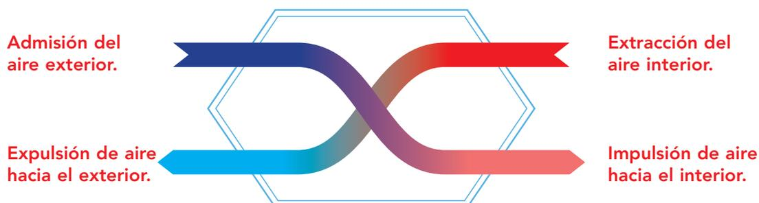
En el caso de ventilación mecánica controlada, hablamos de recuperadores de energía (y en el caso de los intercambiadores entálpicos, también de humedad). El aire extraído de la vivienda circula a través de un intercambiador (recuperador), y en sentido contrario y de manera cruzada se hace circular el aire absorbido desde el exterior. Ambos flujos no se mezclan, pero hay una transferencia de energía de uno a otro.
